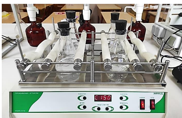
3.3 Сурет – ПЭ-6300 зертханалық шейкері
